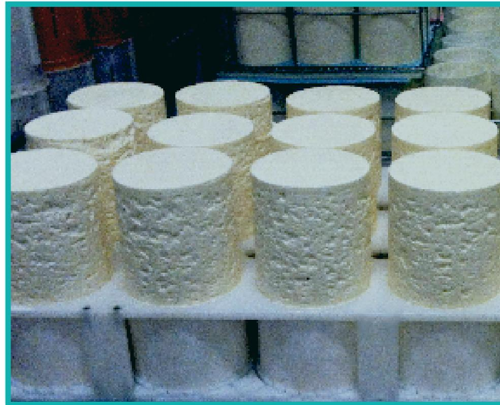
Le système double fond et la perforation assurent à la fois un **moulage et un égouttage sécurisés** avec la possibilité d'**empilage moule sur moule**.
